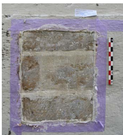
Resultaat na decapering met warme lucht op de witsteen
