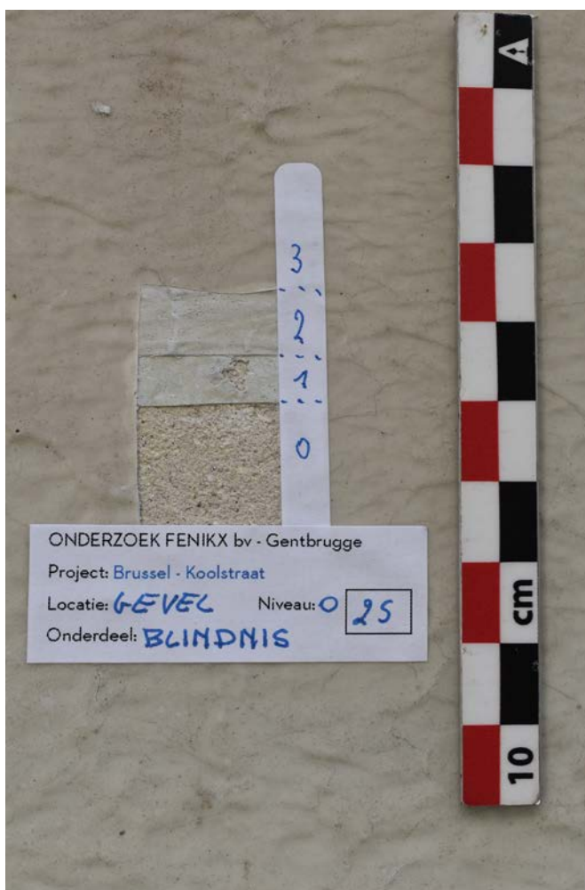
Stratigrafie in een blindnis van de sokkel kant Anjelierenstraat: witsteen + twee verflagen (1-2) en een anti-graffitilaag (3)
