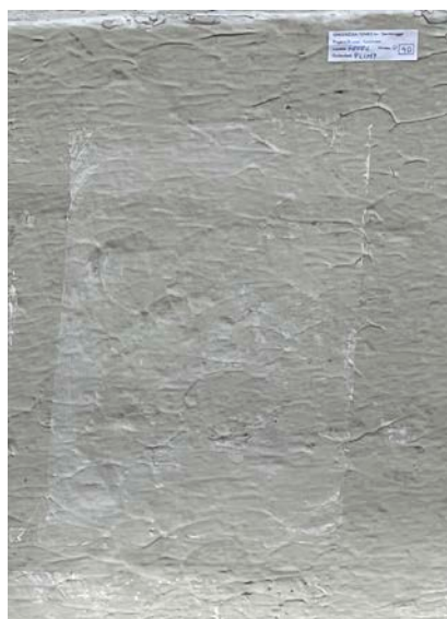
Resultaat na een inwerktijd van 30 minuten Afbijt van het merk Polyfilla is nihil
