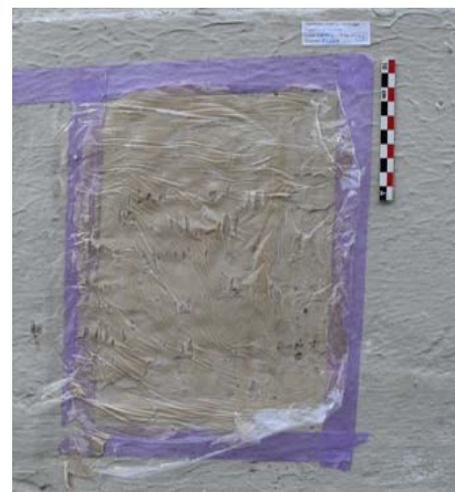
Decaperingstest met Super Afbijt van het merk Polyfilla
